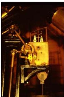
Este sistema con partes faltantes e imposibilitado de ser recuperado para la actividad observacional fue preservado en la sala de antiguos instrumentos tras un trabajo de conservación y reemplazado a fines de la década del 80 por un motor sincrónico con variador de frecuencia para poder hacer ajustes en la velocidad acordes a un uso mas actual del telescopio.
